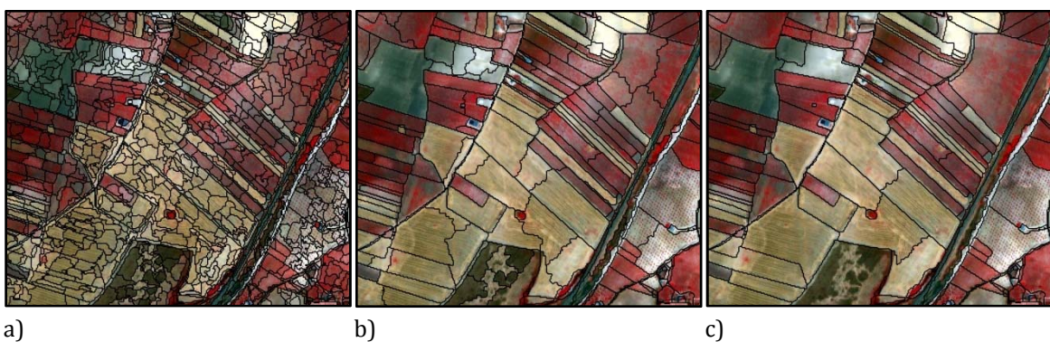
Figura 2.6. Resultado de la segmentación al variar el parámetro factor de escala: a) factor de escala=10; b) factor de escala=30 y c) factor de escala=50.
