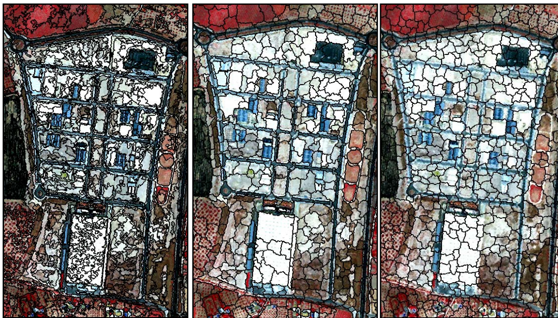
Figura 1.1: Ejemplo de segmentación de una imagen con distintos parámetros de segmentación. Segmentación ponderando la componente espectral de la imagen en a) un 100%, b) un 50% y c) un 10% respecto a la componente de forma.
