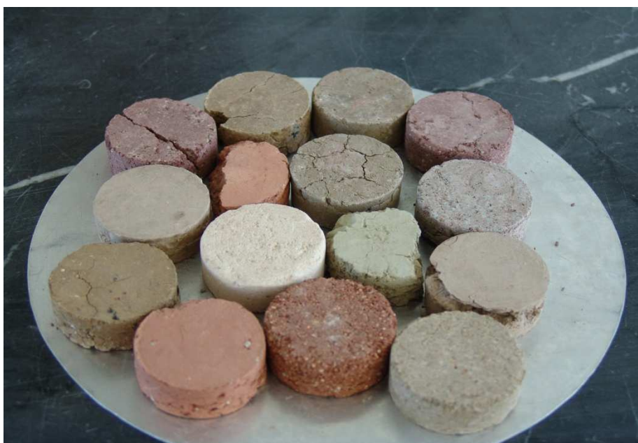
Figura IV 3. Probetas sometidas al ensayo edométrico
