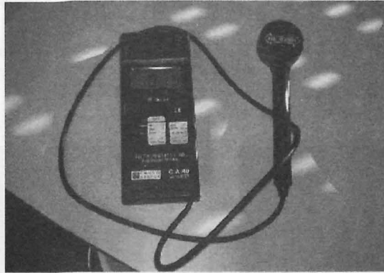
figura3: MEDIDOR DE CAMPO MAGNÉTICO
