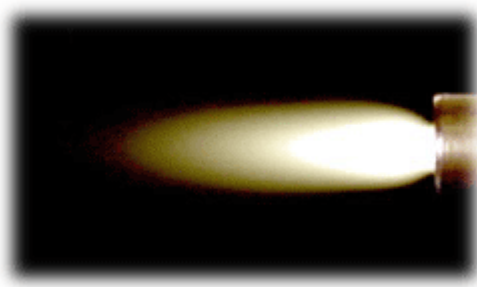
Figura I.7: Antorcha de plasma a presión atmosférica.
