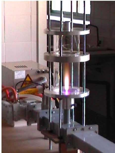
Figura I.8: Antorcha de Inyección Axial con reactor acoplado.
