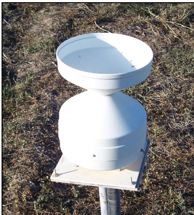
Figura 8. Pluviómetro modelo ARG100 de Campbell Scientific Ltd.
