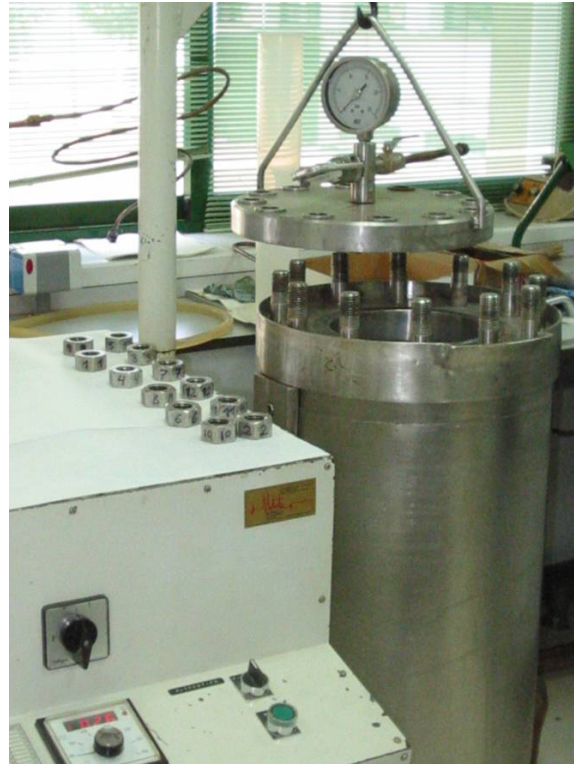
Figura II-1. Reactor para los tratamientos hidrotérmicos y pasteado de la materia prima
