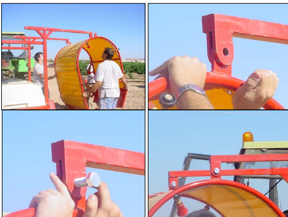
Figura 8.18.-Proceso de montaje de túneles.
