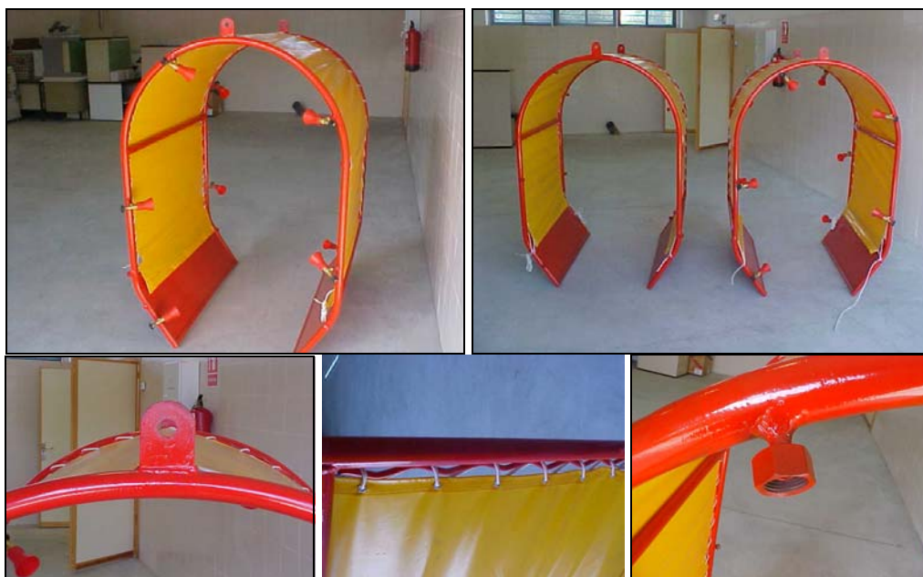
Figura 8.16.-Detalle de túneles, de enganche a la estructura soporte, de fijación de lonas y de conexión de boquillas.
