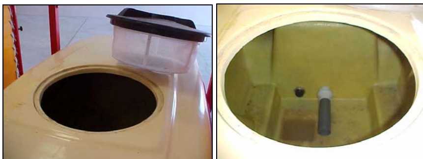
Figura 8.14.-Detalle de filtro de llenado y de agitador hidráulico.
