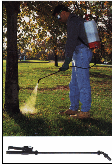
Figura 6.24.- Aplicador tipo lanza y detalle de la pulverización.
