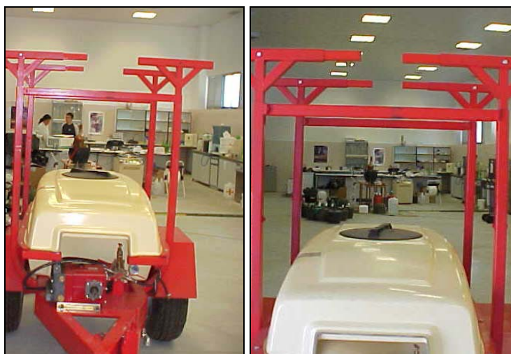
Figura 8.15.-Detalle de bastidor de soporte de túneles.
