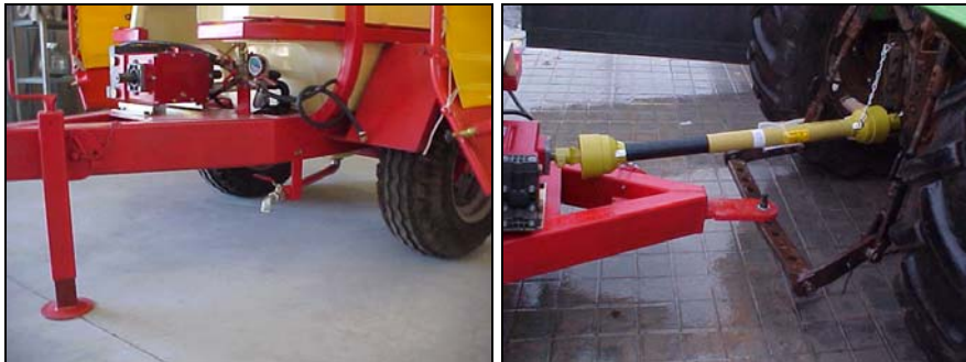
Figura 8.12.-Detalle de bastidor, bomba, enganche al tractor y junta cardan de accionamiento de la bomba.
