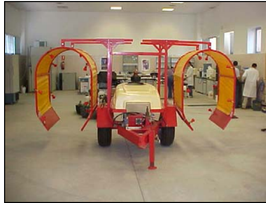
Figura 10.3.- Prototipo construido para el ensayo.
