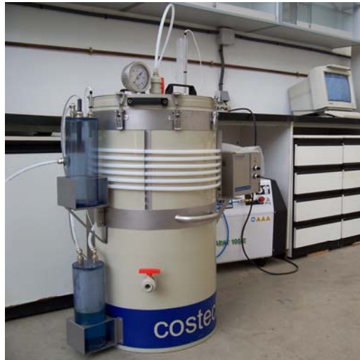
Figura 47. Equipo de respirometría para la determinación del índice de respiración dinámica.
