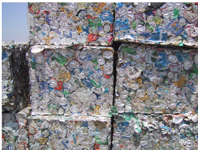
Figura 16. Las latas separadas mediante corrientes de Foucault y posteriormente prensadas.
