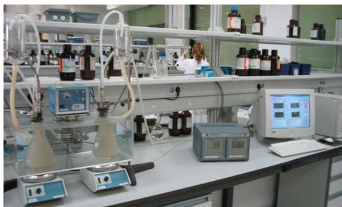
Figura 41. Equipo de respirometría compuesto de PC de control, modulo de acondicionamiento de señales y los reactores.
