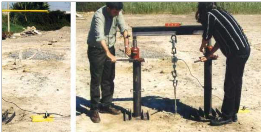
Fig. 34: Izqda.: Separación del potenciómetro de la estructura de reacción; Dcha.: Realización de un ensayo.
