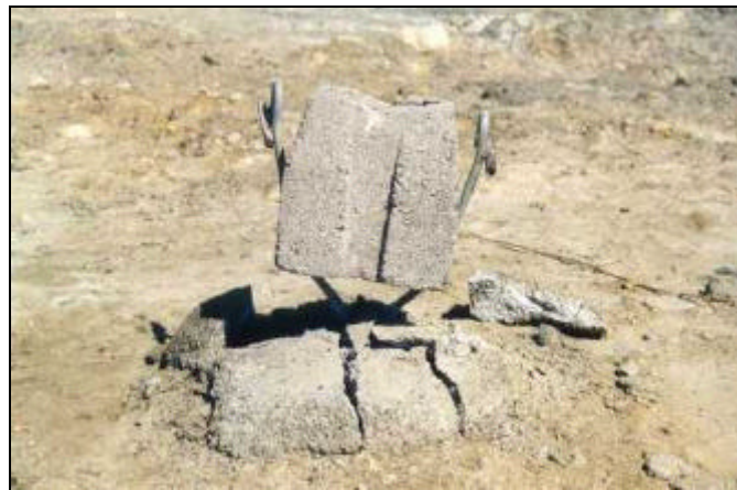
Fig. 92: Estado del anclaje tipo 1 tras ser ensayado.
