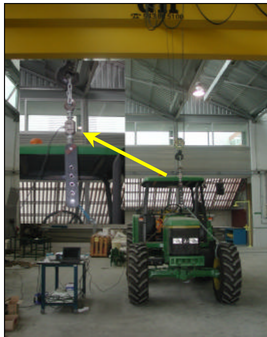
Fig. 61: Proceso de calibración de la célula de carga.
