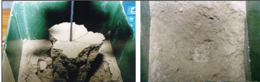
Fig. 84: Izqda.: Anclaje elevando una masa de suelo tras concluir el ensayo; Dcha.: Aspecto del cubo de ensayos tras desalojar el volumen de suelo implicado en la rotura.
