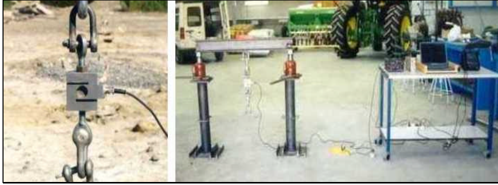
Fig. 36: Izqda.: Célula de carga; Dcha.: Estructura de reacción y sistema de adquisición de datos.
