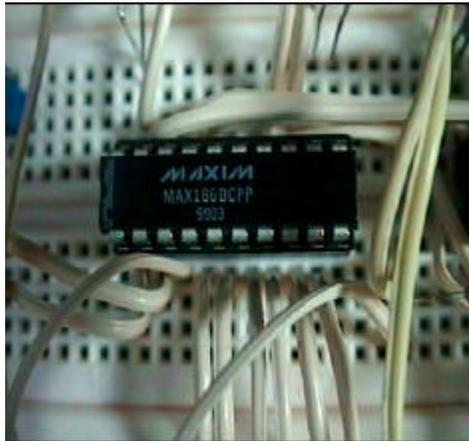
Foto 11. Convertidor A/D de aproximaciones sucesivas de 12 bits y 8 canales.
