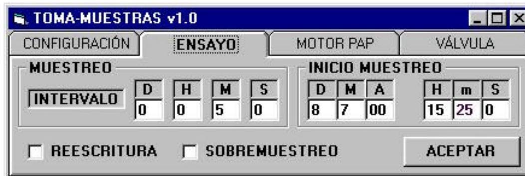
Figura 65. Pantalla de configuración del ensayo en la aplicación Toma-muestras v1.0
