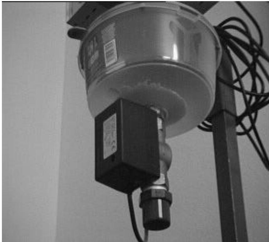
**Foto 2. Detalle del depósito para el fluido percolado y válvula de descarga.**
