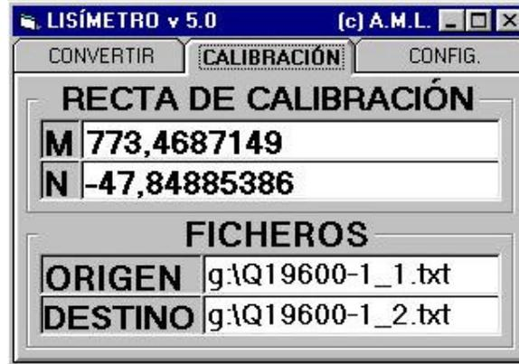
Figura 49. Pestaña de calibración para la aplicación Lisímetro v5.0
