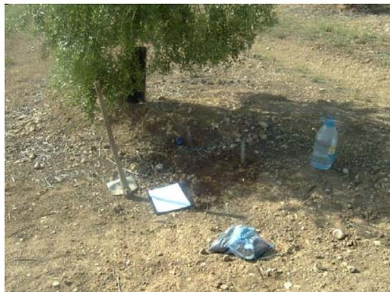
**Figura 1.26.** Ensayo de  $K_{sat}$  en una zona la ladera S con mejores condiciones de infiltración.
