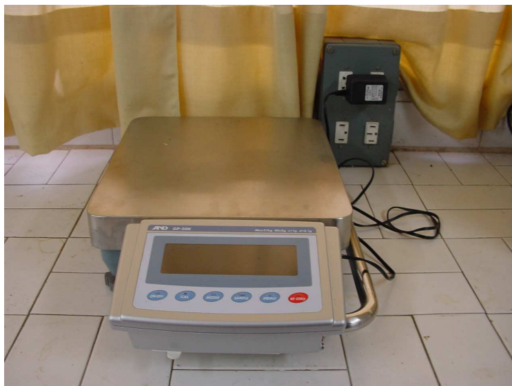
Figura 3. Balanza electrónica usada para determinar el peso de aceituna.
