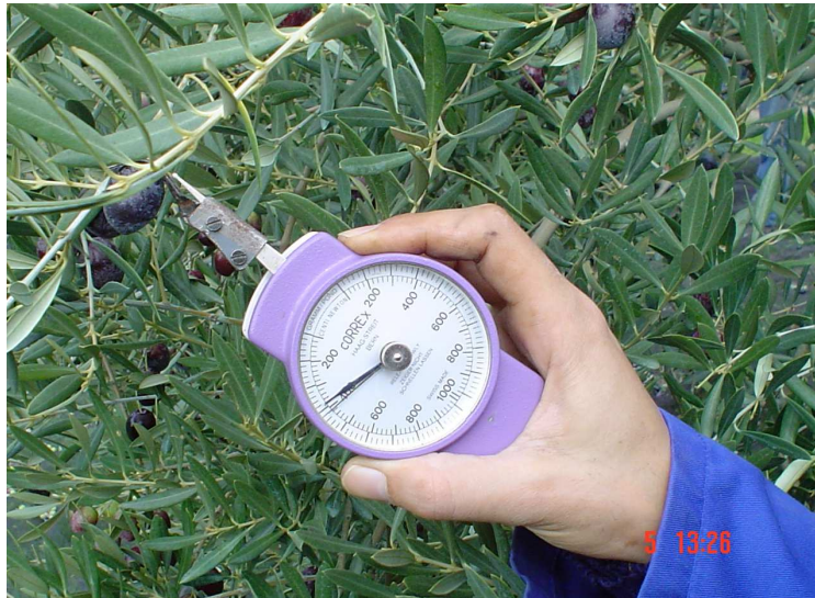
Figura 2. Dinamómetro adaptado para medidas de Fuerza de Retención del Fruto (FRF).
