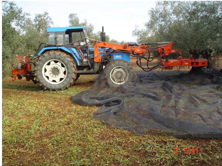
Figura 19. Conjunto Tractor-Vibrador utilizado en los ensayos.
