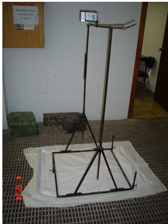
Figura 6. Bastidor utilizado en los ensayos para enfocar la cámara de video.
