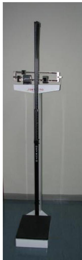
Imagen 15. Balanza con estadiómetro Detecto.
