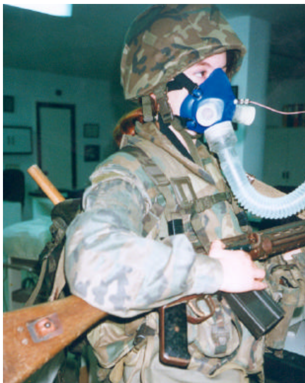
FIGURA 11: Aplicación de la mascarilla que está conectada a una válvula de 2 vías y que a su vez se conecta a un tubo capilar y al analizador de gases. También se observa el tubo coarrugado que contacta con el neumotacógrafo.
