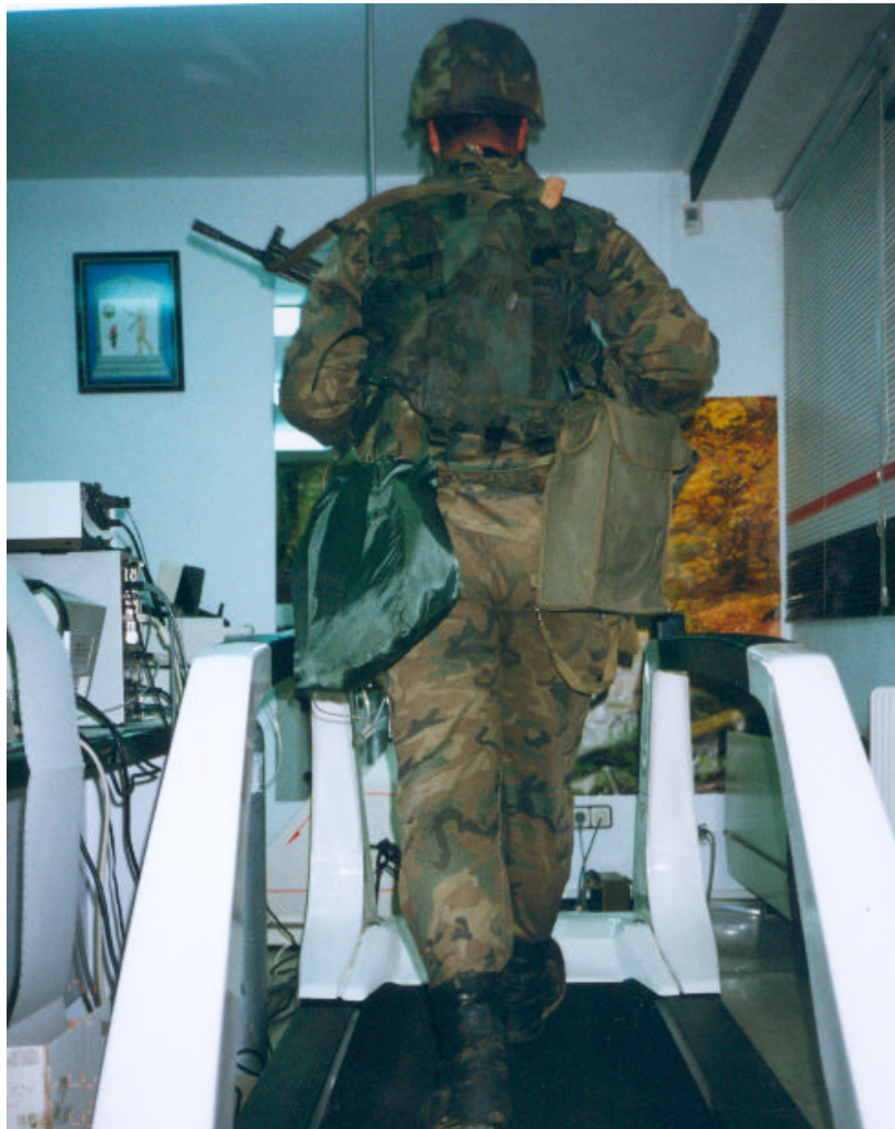
FIGURA 10: Imagen posterior de un soldado durante el desarrollo de la fase 2. Se observan los componentes del equipo del soldado que incluye la mochila, el portaequipo de combate y el equipo de protección individual NBQ.
