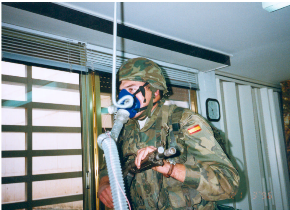
FIGURA 3: Detalle de la fijación a la boca de la mascarilla y del tubo coarrugado durante el desarrollo de la fase 1 del protocolo.
