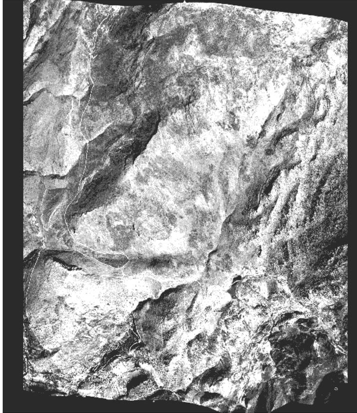
**Figura A2-5. Ejemplo de ortofoto recortada por el oeste para generar posteriormente un mosaico.**
