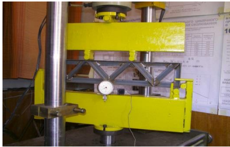
Рисунок 2 – Дослідження фізичної моделі зварної ферми
