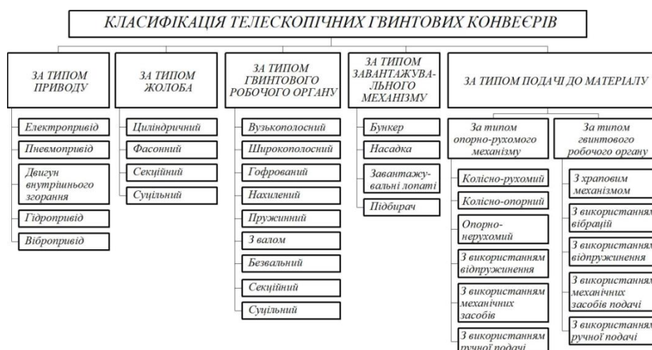
Рисунок 1 - Класифікація телескопічних гвинтових конвеєрів за конструктивними ознаками
