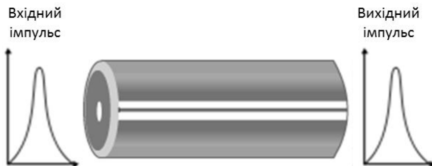
Рис. 2.10. Розповсюдження світла в одномодовому ВОК
