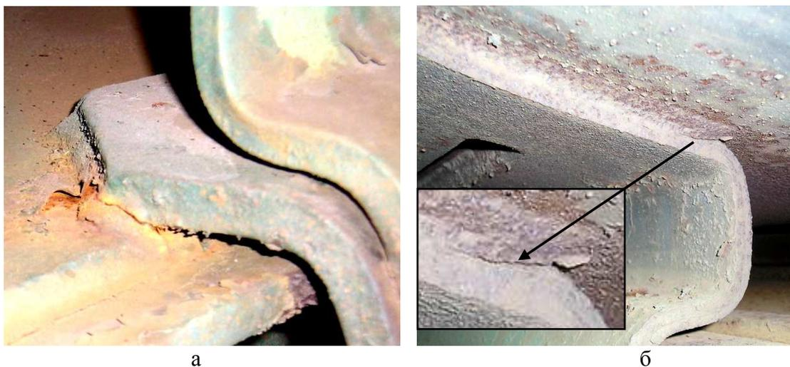
Рис.2. а) зона сварного шва рамной лапы в месте крепления к хребтовой балке
