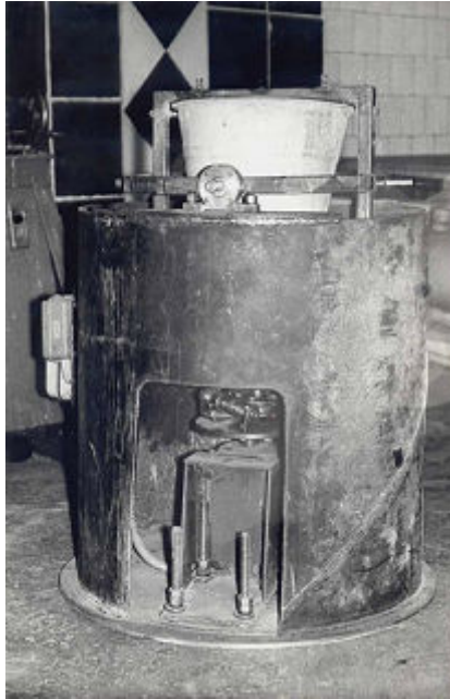
Рисунок 2. Експериментальна вібраційно-відцентрова установка Figure 2. The experimental vibration-centrifugal device
