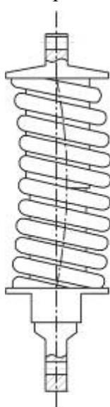
Рис. 1. Нерівномірне просідання пружини стиску
