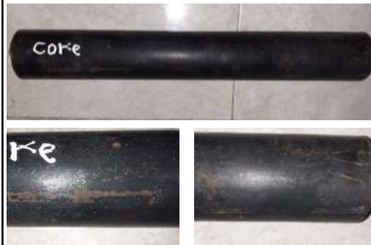
Hasil proteksi menggunakan coal coke breeze backfill
