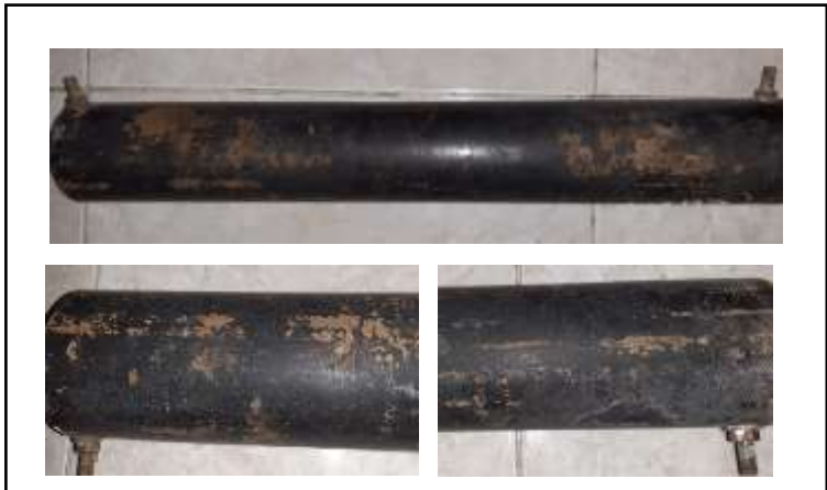
Gambar 4.14 Keadaan Pipa API 5L Setelah Mengalami Proteksi Menggunakan Chemical Backfill
