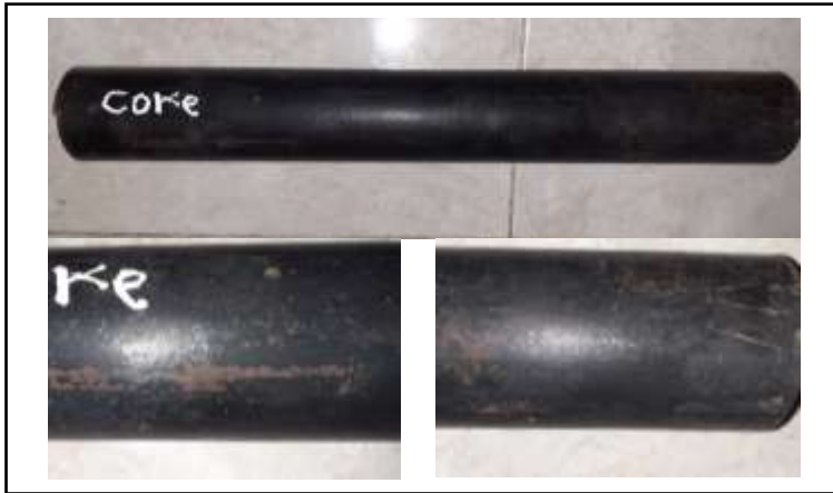
Gambar 4.12 Keadaan Pipa API 5L Setelah Mengalami Proteksi Menggunakan Coal Coke Breeze Backfill
