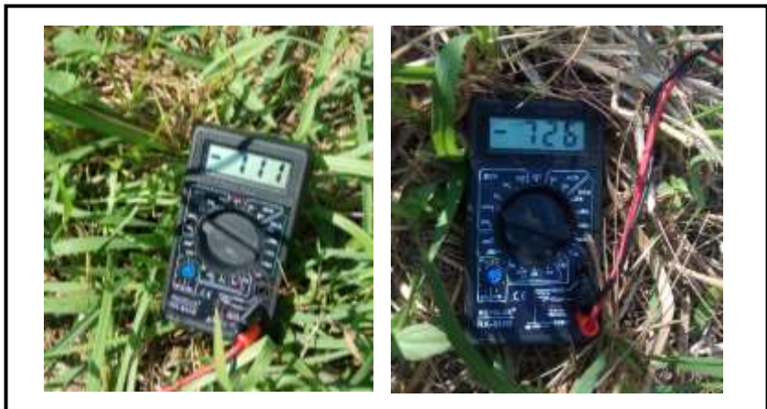
Potensial proteksi yang terukur pada pengujian pada pipa baja API 5L grade B
