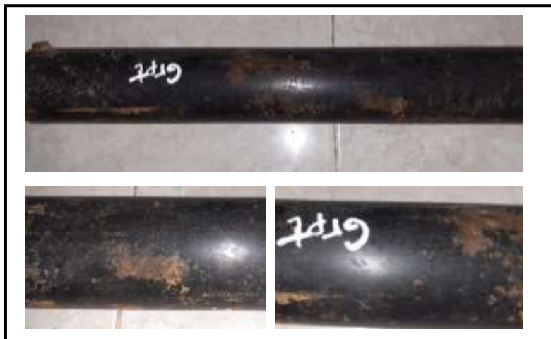
Hasil proteksi menggunakan graphit backfill
