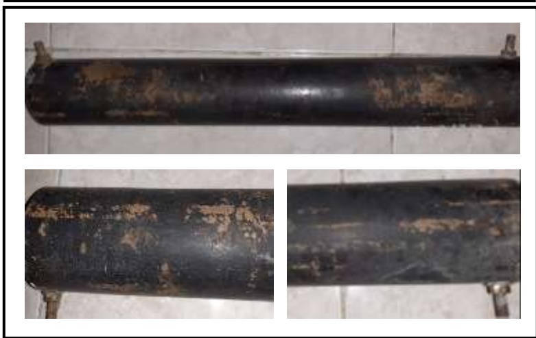
Hasil proteksi menggunakan chemical backfill
