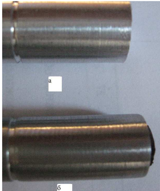
Рисунок 11. Фотографія обробленої деталі а) при однолезовій обробці, б) багаторізцевою головкою адаптивного типу з пружними напрямними та електромагнітним приводом
