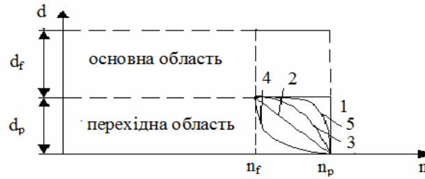
Рисунок 3. Модель частково неоднорідної плівки (розподіли показника заломлення: 1 – ступінчастий; 2 – лінійний; 3 – квадратичний; 4 – логарифмічний; 5 – експоненціальний)
