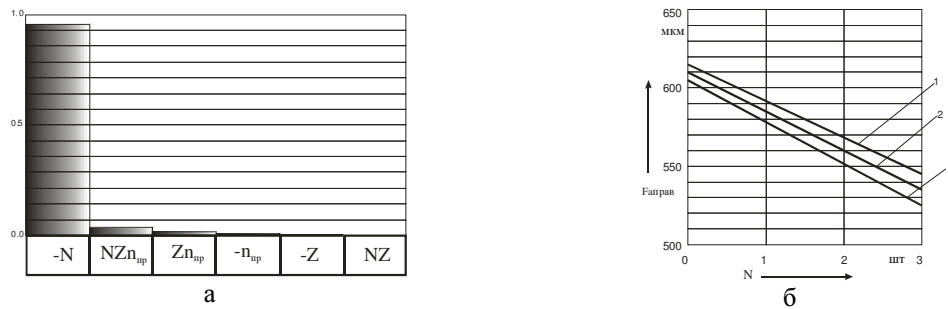
Рисунок 3. Відхилення вихідного контуру черв'ячного колеса правої сторони F_{\text{апрає}} , мкм: а – ступінь впливу змінних факторів; б – залежність F_{\text{апрає}} від N та Z ( n_{\text{np}}=1 ); 1 – Z=6 ; 2 – Z=9 ; 3 – Z=12 шт
