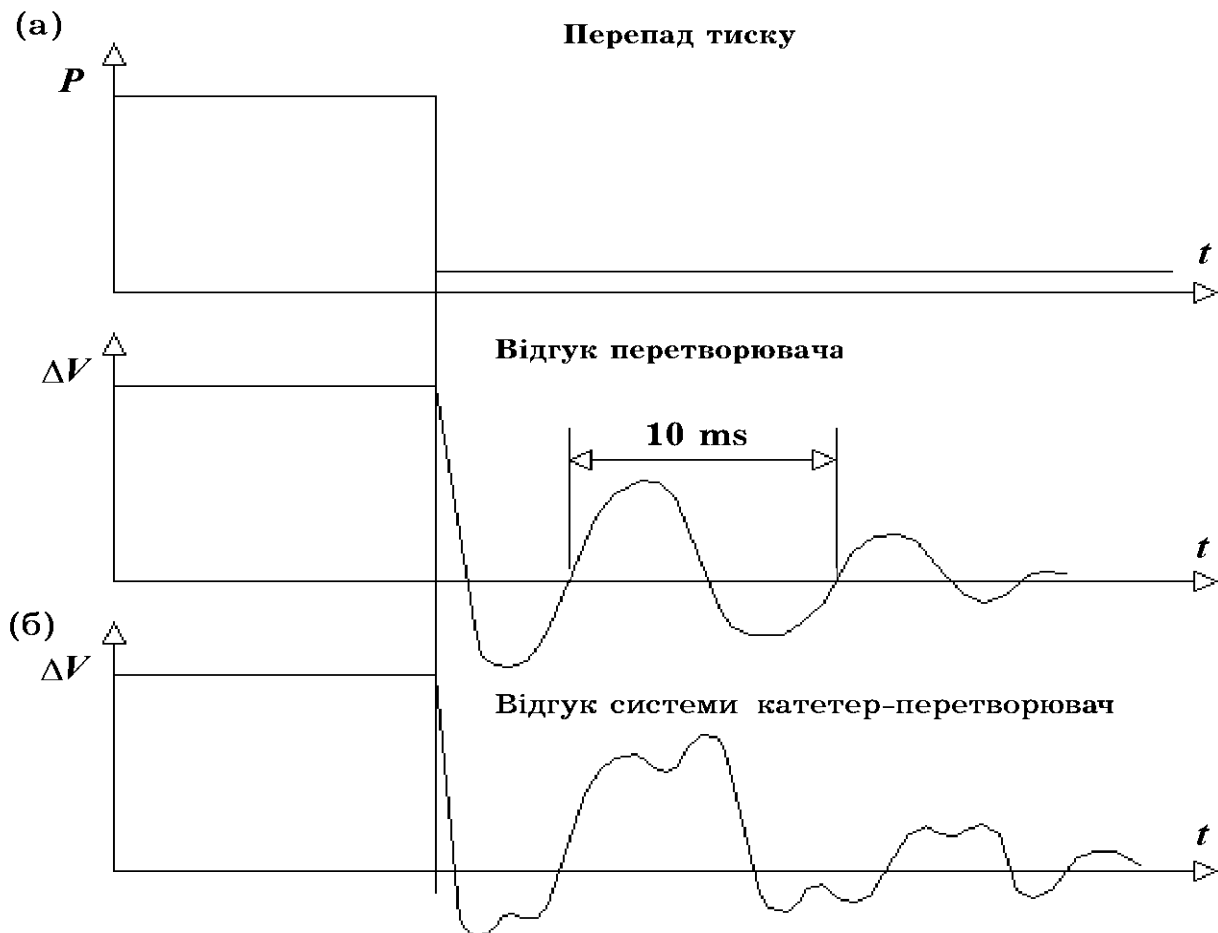
Рис.1.6. Відгук перетворювача на перепад тиску: (а) — перехідні характеристики перетворювача; (б) — перехідні характеристики системи катетер-перетворювач.
