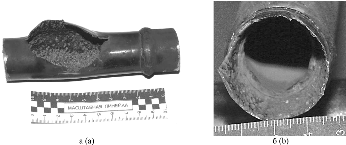
Рисунок 2. Руйнування трубного елемента на ділянці з ерозійно-корозійним зношуванням (а). Внутрішня і зовнішня поверхні теплообмінної трубки-змійовика \text{Ø}32 \times 4 після руйнування біля зварного шва (б)
