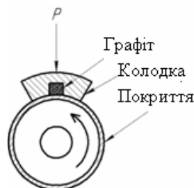
Рисунок 8. Схема випробувань зносостійкості покриттів на сухе тертя з графітною вставкою Figure 8. Scheme of wear resistance tests with counterbody with built in graphite under dry friction condition
