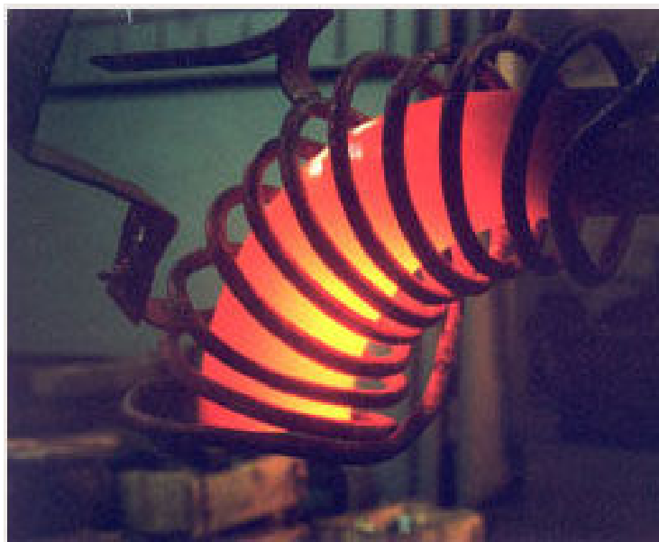
Рисунок 1. Індуктори промислових зразків для нагріву деталей при гартуванні
