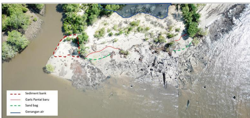
Gambar 3. Model Perubahan garis pantai dan usaha perbaikan fisik pantai Sumber: Hasil Analisis Data (2023) dengan Peta Lokasi Penelitian dari www.googleearth.com
