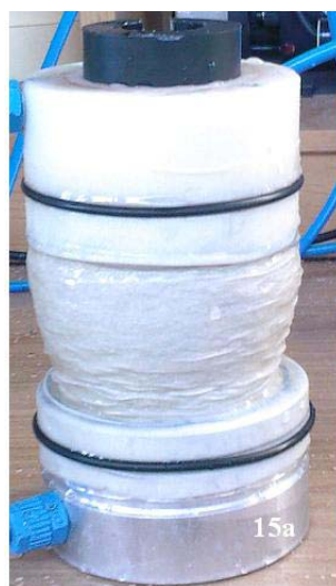
Figur 56: Prøveemne der ikke har udvidet sig jævnt over tværsnittet pga. friktion mellem de nederste latexhinder.
