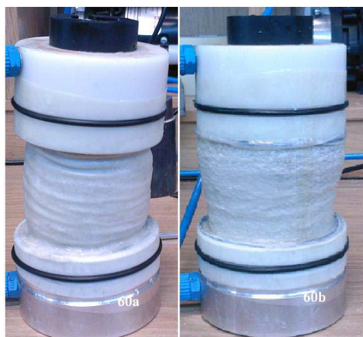
Figur 148: Prøveemner ved et kammertryk på 60kPa
