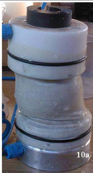
Figur 55: Skævt belastet prøveemne.
