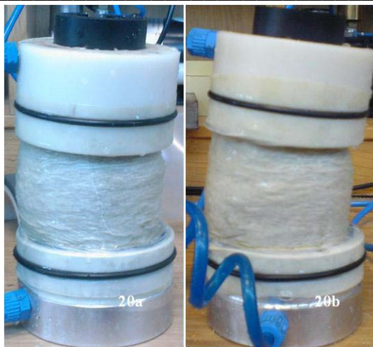
Figur 145: Prøveemner ved et kammertryk på 20kPa
