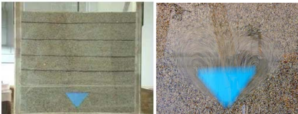
Figur 7: Plan modelforsøg. Til venstre forsøget uden belastning og til højre brudmekanismen under belastning. Kilde: FODPÆLE – Alternativ funderingsmetode til vindmøller
