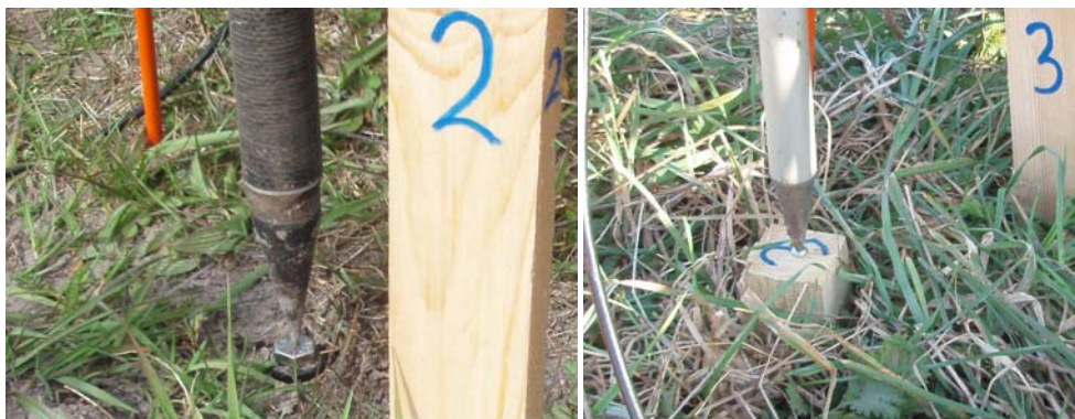
Figur 7.10: Billedet t.v. viser et punkt hvor der er benyttet et jernrør mens t.h. en træpløk.
