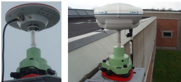
Figur 6.5: De to GNSS antenner, der indgår i forsøget (Leica t.v., Trimble t.h.).
