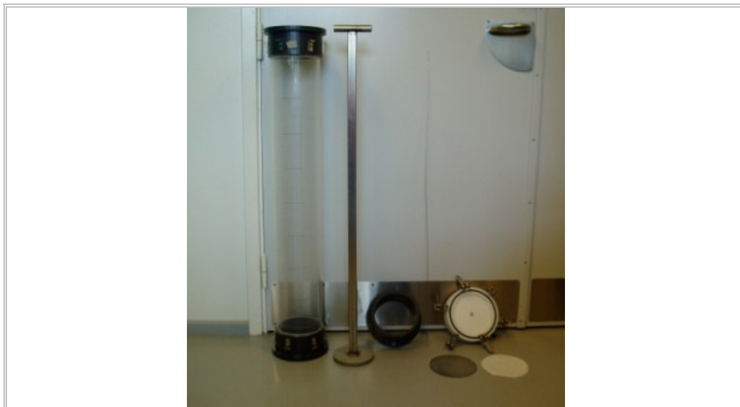
Figur 3.4: Billede af det udstyr der benyttes til pakning af kolonnerne. Fra venstre mod højre ses: Kolonne til pakning af materiale, stamper, top (benyttes ved pakning af top lag), metalstang til løsning af materialet, endestykke til kolonne, foran den ses (til indsats i endestykket for tilbageholdelse af materialet): metalgitter samt elefantpapir.
