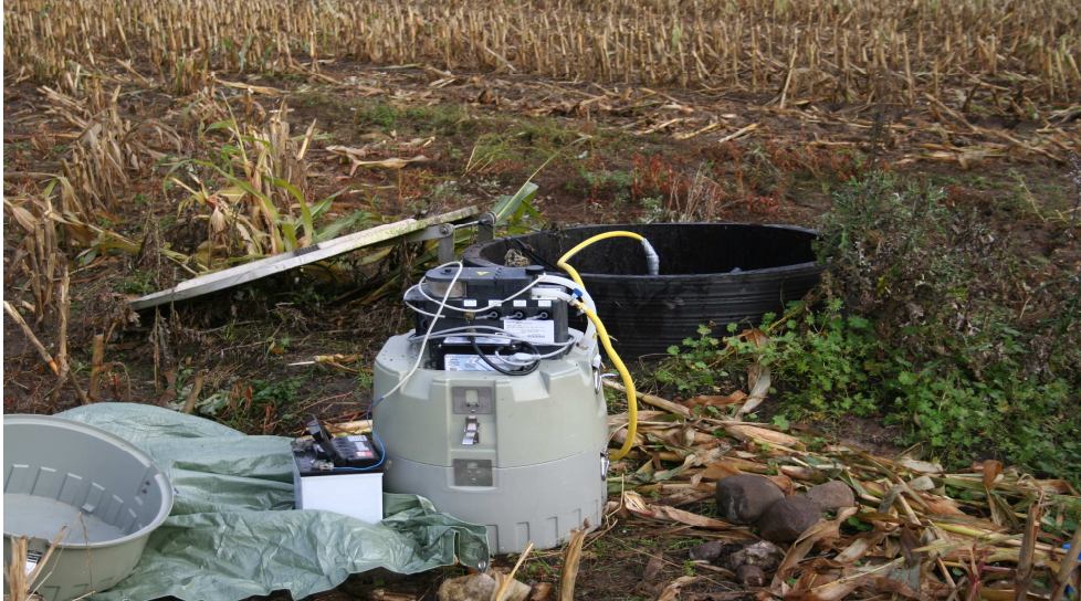
Figur 11. Autosampler opstillet ved oppumpningsbrønd.
