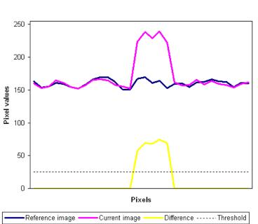
$i_{(x,y)} = \begin{cases} |A_{(x,y)} - R_{(x,y)}| & \text{if } |A_{(x,y)} - R_{(x,y)}| > \varepsilon_S \\ 0 & \text{otherwise} \end{cases}$
