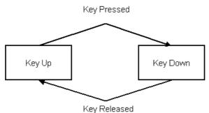
Fig. 3.4.2: PianoKey State Diagram
