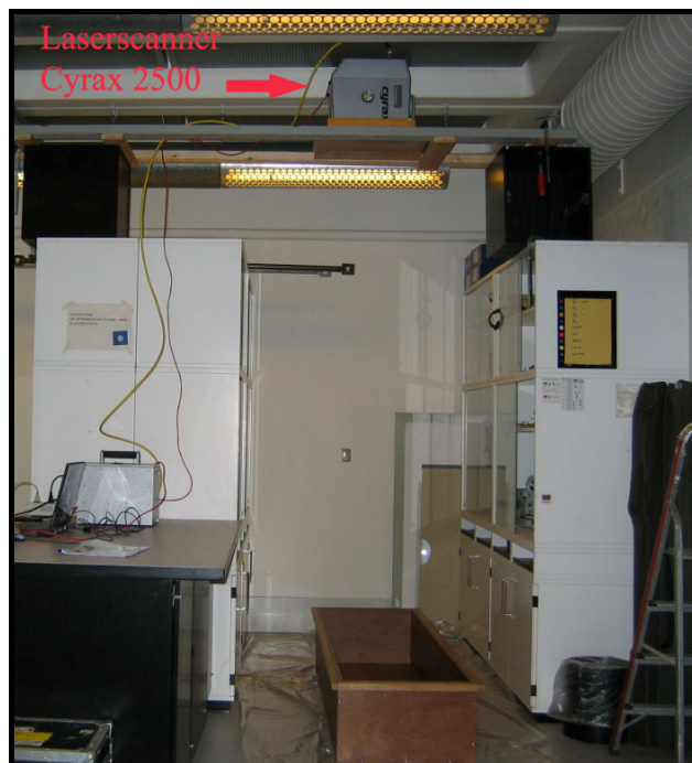
Figur 6.4: Opsætningen af Cyrax 2500 over trækassen.
