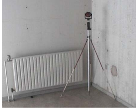
Figur 10.2: Illustration af problemer med at måle radiatoren i rum 5.17 pga. skygger fra prismestativ.
