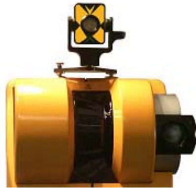
Figur 7.8: Laserscanner med prisme monteret. [www.trimblecenter.dk]
