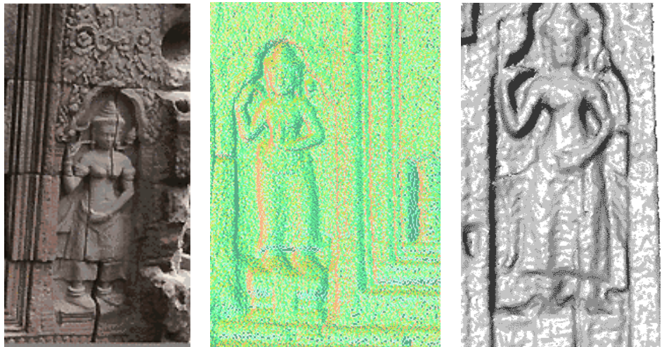
Figur 3.8: Et eksempel på rekonstruktion af en bygningsfacade – til venstre selve billedet, i midten punktskyen og til højre den færdige model for bygningsfacaden. [www.callidus.de]
