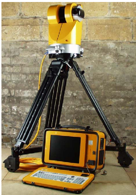
Figur 5.1: Laserscanningssystem fra Callidus, laserscanneren er en Callidus V1-1. [Callidus, 2001a]
