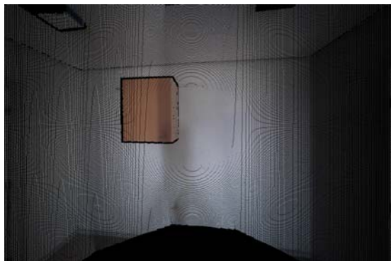
Figur 5.7: Eksempel, hvor der er tildelt en RGB-værdi til punkterne. Udsnittet er fra en punktsky i rum 5.17 i testområde, som er nærmere omtalt i Afsnit 7.1.
