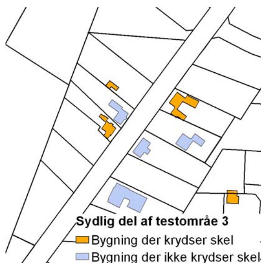
Figur 71. Testresultat efter korttilpasning. De viste bygninger er alle udpeget i model 1. De blå bygninger krydser ikke længere skel efter korttilpasningen.
