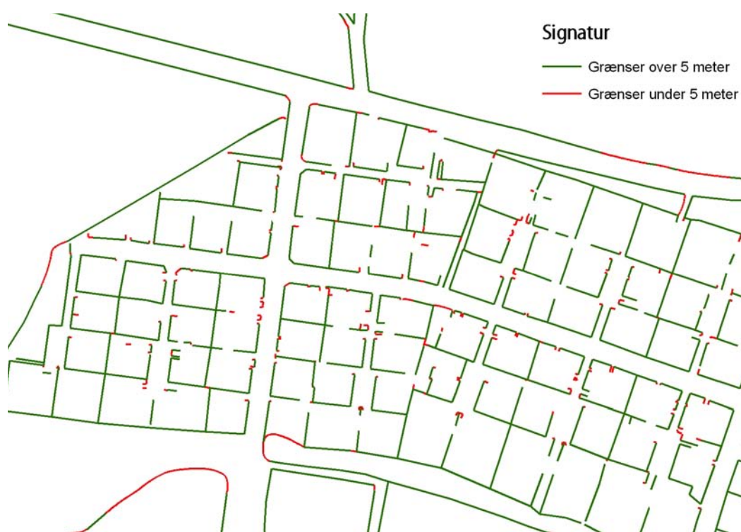
Figur 52. Eksempel der viser hvilke grænser der fjernes i trin 3a
