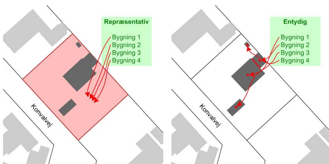
Figur 74. Repræsentativ (venstre) og entydig (højre) georeference. Eksemplet tager udgangspunkt i dataene for Dronninglund Kommune.
