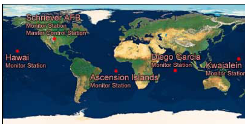
Figur 12: De fem kontrolstationer, som tilsammen udgør kontroldelen i GPS [www.kowoma.de/gps/ Umlaufbahnen.htm].
