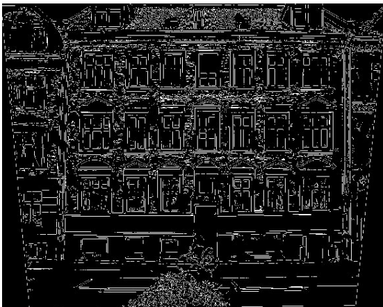
Figur 24: Østerbro 48. Kantpixler detekteret med Canny filter. Grænseværdien er 0.05/0.1.
