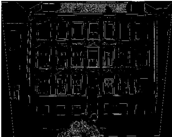
Figur 10: Østerbro 48. Kantpixler detekteret med Prewitt filter. Grænseværdien er sat automatisk.
