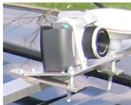
Figur 5.7: Kameraet er monteret på en sådan måde, at det så vidt det er muligt sidder ens efter af- og påmontering, og at der kan vælges forskellige indstillinger af hældningen på kameraet inden systemkalibreringen.
