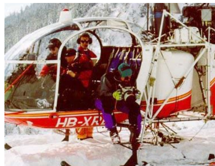
Figur 2.13: En person i helikopteren kan sidde med MKS'et bestående af kamera, GPS og IMU, hvilket gør systemet fleksibelt. [Vallet, 2000, s. 5]
