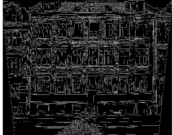
Figur 12: Østerbro 48. Kantpixler detekteret med Canny filter. Grænseværdien er sat automatisk.
