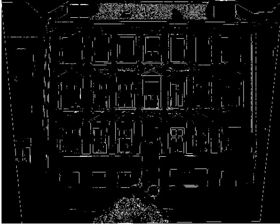
Figur 9: Østerbro 48. Kantpixler detekteret med Sobel filter. Grænseværdien er sat automatisk.
