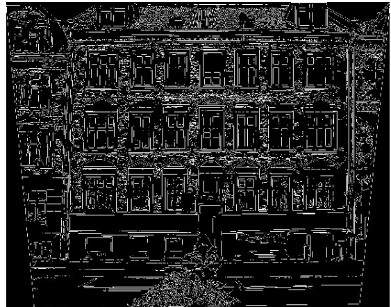
Figur 27: Østerbro 48. Kantpixler detekteret med Canny filter. Grænseværdien er 0.01/0.1.
