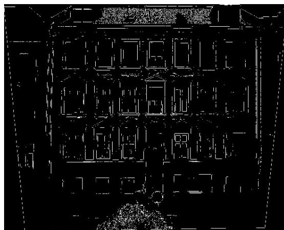
Figur 6.11: Østerbro 48. Detektering af kantpixler med Sobel filteret. Automatisk bestemt grænseværdi i Matlab.
