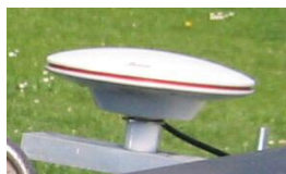
Figur 5.3: GPS-antennen er monteret på aluminiumsprofilen. Som mellemstykke er indsat et stykke af nylon.
