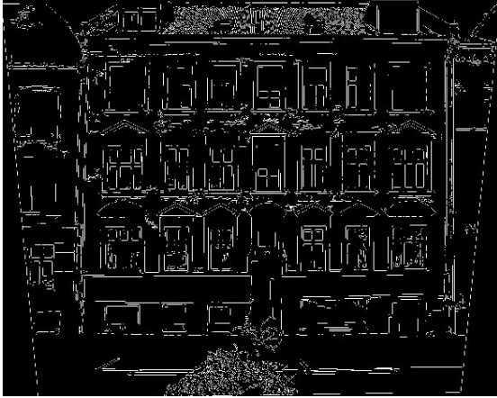
Figur 28: Østerbro 48. Kantpixler detekteret med Canny filter. Grænseværdien er 0.01/0.2.
