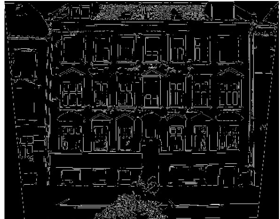
Figur 25: Østerbro 48. Kantpixler detekteret med Canny filter. Grænseværdien er 0.05/0.2.
