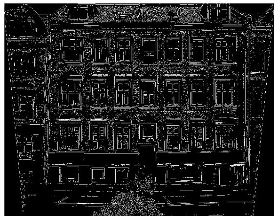
Figur 21: Østerbro 48. Kantpixler detekteret med LoG filter. Grænseværdien er 0.005.
