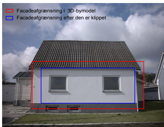
Figur 6.22: Den røde linje viser facadeafgrænsningen i 3D-bymodellen projiceret ind i det oprettede billede med restfejl. Den blå linje viser, hvor meget der kommer med af facaden i det endelige facadebillede, efter der er klippet af billedet for at kompensere for tagudhængsproblematikken, 3D-bymodellens unøjagtighed samt fejl på den ydre orientering. Jo bedre den ydre orientering er, des mindre skal der klippes af facaden for at undgå himmel med mere i facadebilledet.
