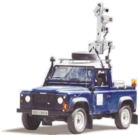
Figur 2.12: MKS fra Citygrid bestående af laserscanner, digitalt kamera samt GPS-antenne. [CityGrid Scanner]
