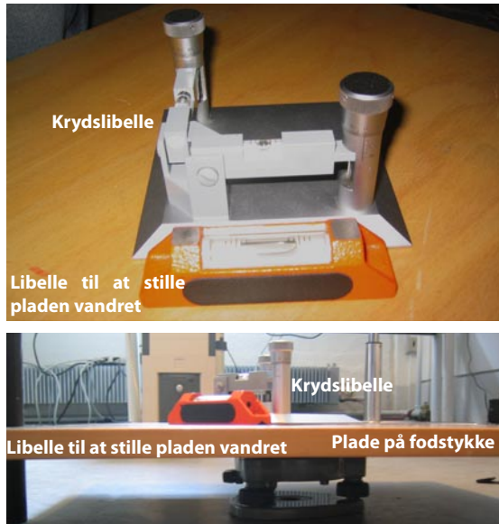
Figur 5.25: Verifikation af krydslibellen. Øverst ses krydslibellen og libellen, der anvendes til at sætte pladen vandret. Nederst ses opstillingen med libellerne på pladen på fodstykket.
