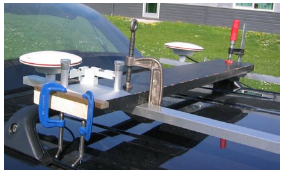
Figur 5.24: Krydslibellen placeres i en anordning, således at den kan placeres samme sted, hver gang referencen måles. Endvidere er den placeret parallel med det plan, der udspændes af GPS-antennerne, og libellerne er placeret parallel med akserne i bilens koordinatsystem.
