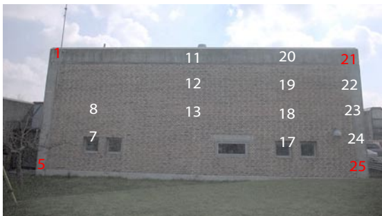
Figur 7.2: Punkterne på facaden Fibigerstræde 14 målt i forbindelse med systemkalibreringen anvendes som henholdsvis fiktiv facade (røde) og kontrolpunkter (hvide). Koordinaterne til punkterne er i bilens koordinatsystem.
