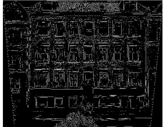
Figur 13: Østerbro 48. Kantpixler detekteret med LoG filter. Grænseværdien er sat automatisk.
