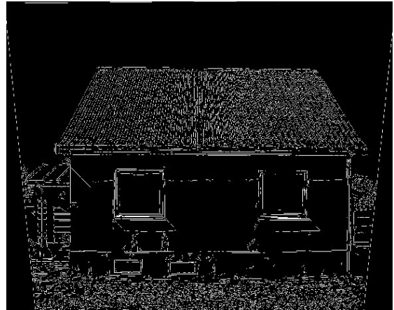
Figur 6: Hadsundvej 170. Kantpixler detekteret med Canny filter. Grænseværdien er sat automatisk.
