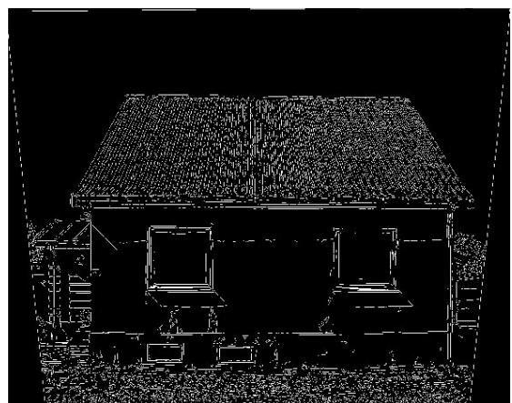
Figur 8: Hadsundvej 170. Kantpixler detekteret med Zero-cross filter på et Canny filter. Grænseværdien er sat automatisk.
