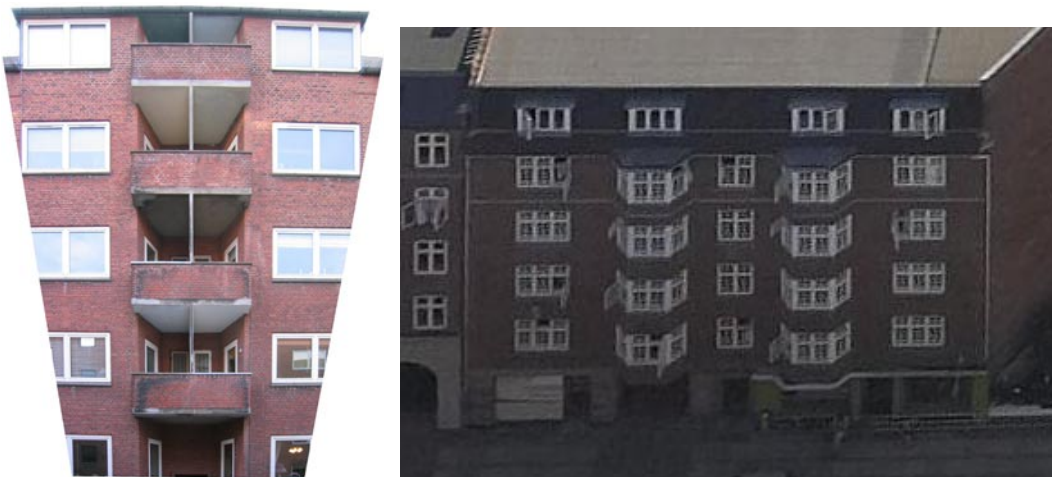
Figur 2.19: Til venstre ses en oprettet facade fra et terrestrisk foto. Altanerne giver indtryk af, at bygningen ses fra gadeplan. Til højre ses en oprettet facade fra et skråfoto. Her giver karnaperne indtryk af, at facaden ses fra oven. [CD fra COWI]
