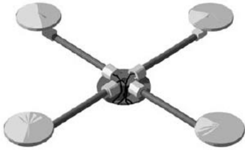
Figur 4.13: GPS-antennesystemet ADU5 fra Thales Navigation. [www.thalesnavigation.com]
