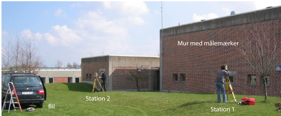
Figur 5.8: Situation ved indmåling af paspunkter på mur og GPS-antenner på bilen. Opmålingen sker ved fremskæring fra to totalstationer.
