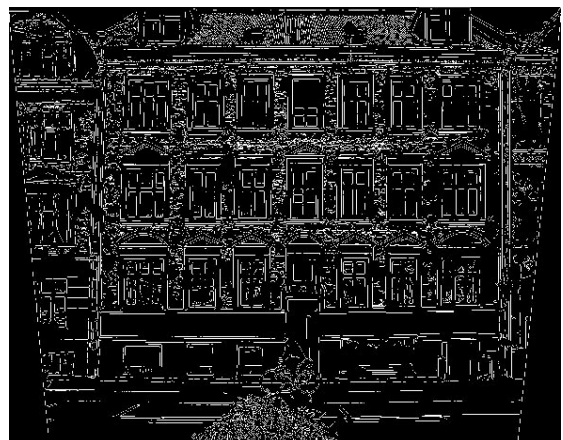
Figur 14: Østerbro 48. Kantpixler detekteret med Zero-cross filter på et Canny filter. Grænseværdien er sat automatisk.
