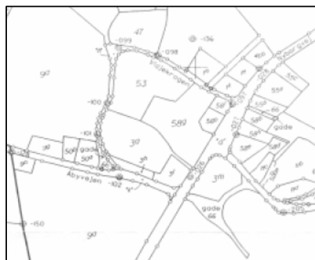
FIGUR 12 Et eksempel på det digitaliserede matrikel. Eksemplet er fra 1993 og viser samme område, som det "originale" (Figur 4-6). Skelpunkter der er markeret med cirkler er etableret i kortet på baggrund af fikspunkter og matrikulære målinger. [Enemark, 2002-1, s.6]
