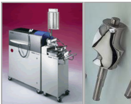
Figura IV.4. Polylab y geometría de mezclado seleccionada (roller-rotors) (Thermohaake, Alemania)
