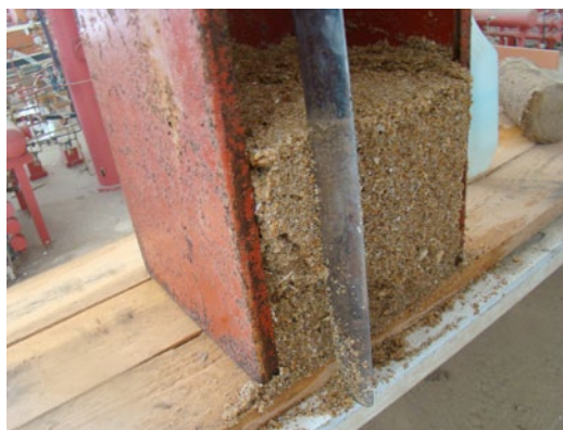
Fig. 3. Alisado del perfil a extraer en una zanja (arriba) y en un testigo en caja (abajo).
