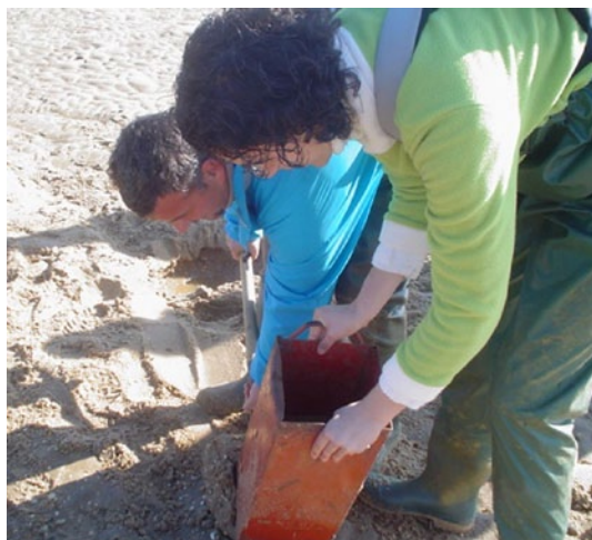
Fig. 2. Zanja cavada en una barra de playa (izquierda) y extracción de un testigo de sedimento en caja (derecha).
