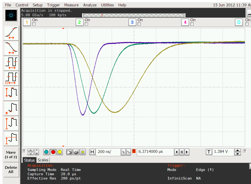
Figura 3.8 Medida experimental de la sintonización del tiempo de pico del shaper.
