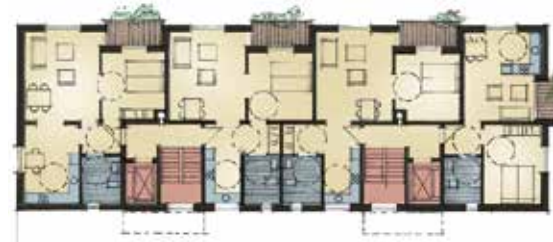
Der er skabt ældreegnede boliger med elevatorer og niveaufri adgang gennem inddragelse af et boligareal fra de tilstødende lejligheder.
