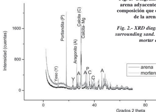
Fig. 2.- Diagrama DRX del mortero y la arena adyacente. Nótese la similitud en composición que denota la contaminación de la arena por el mortero.
