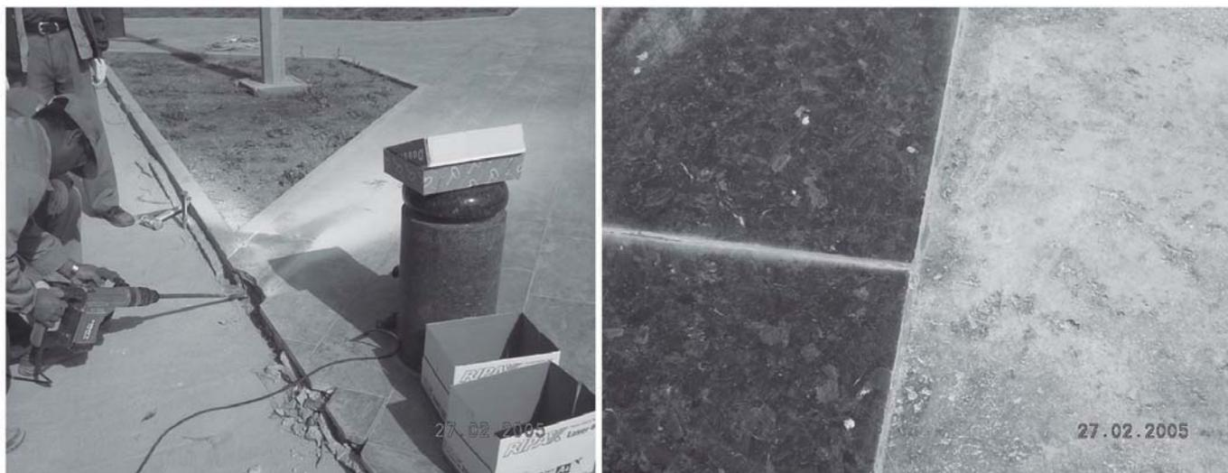
Fig. 1.- a) Toma de muestra de la roca tras la alteración sufrida. b) Detalle del pavimento alterado.
