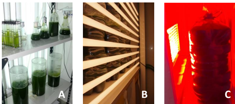
Figura 2.5. (A) Cultivos en cámara climatizada. Cámara climatizada a 25 °C e irradiancia de 140 \mu\text{moles fotones}\cdot\text{m}^{-2}\cdot\text{s}^{-1} de PAR. (B) Cultivos bajo irradiancia saturante de 650 \mu\text{moles fotones}\cdot\text{m}^{-2}\cdot\text{s}^{-1} de PAR. (C) Cultivo bajo alta irradiancia de luces LEDs de color rojo de 1800 \mu\text{moles fotones}\cdot\text{m}^{-2}\cdot\text{s}^{-1} de PAR.
