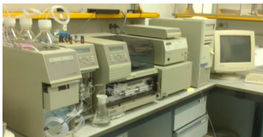
Figura 2.6. Equipo de cromatografía líquida de alta resolución (HPLC) utilizado en la separación y cuantificación de carotenoides específicos.
