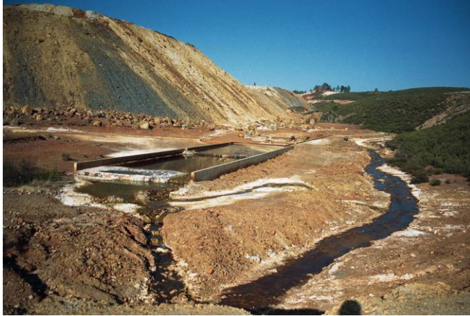
Figura IV.1.8. Red de lixiviados procedentes de las escombreras de la mina de San Telmo. Éstos drenan a través del Barranco de Aguas Agrias hasta desembocar en la rívera de la Panera
