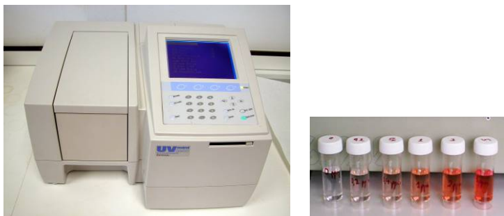
Figura III.4.2. Patrones de calibración y espectrofotómetro SHIMADZU UVmini-1240
