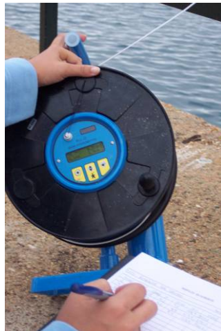
Figura III.5.1. Muestreo perfiles verticales con sonda multi-paramétrica.
