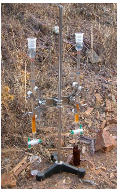
Figura III.3.3. Columnas de vidrio rellenas de resina de intercambio catiónico
