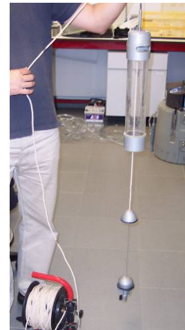
Figura III.5.2. Muestreador empleado en la toma de agua de los embalses a diferentes profundidades
