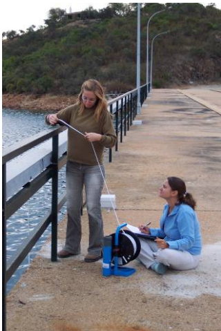
Figura III.5.1. Muestreo perfiles verticales con sonda multi-paramétrica.
