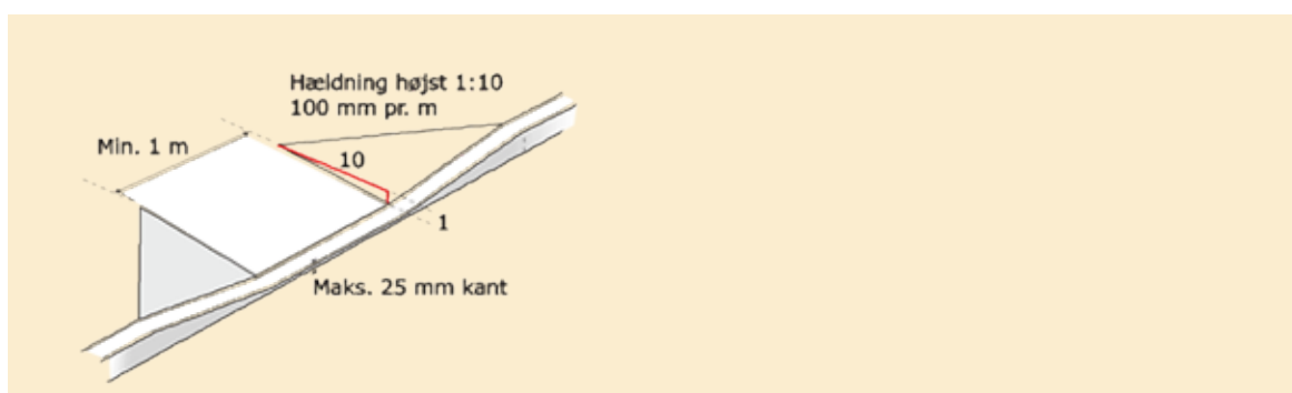
Figur 4. Udligning af små niveauspring ved kantsten kan have en hældning på 1:10.
